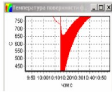
Температура факела и поверхности шихты в роторной печи
